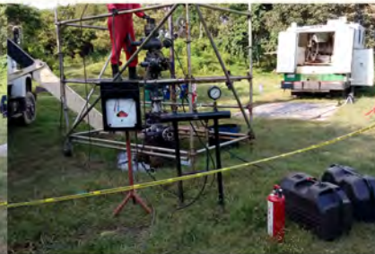
Prueba Hidrostática en medios árboles
